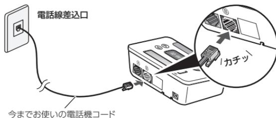
3. 電話機コード接続端子<sup>Ⓐ</sup>（電話機 [灰色の穴]）とお使いの電話機に付属の電話機コードを接続する
